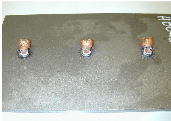
Bolzenschweißungen nach der Schlagbiegeprüfung in der Übersicht.
