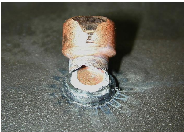
Bolzenschweißung Mitte nach der Schlagbiegeprüfung.
