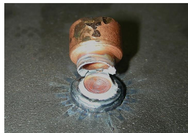
Bolzenschweißung rechts nach der Schlagbiegeprüfung.
