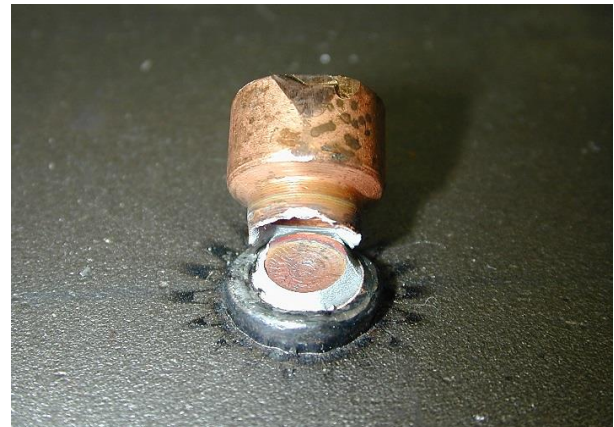
Bolzenschweißung links nach der Schlagbiegeprüfung.
